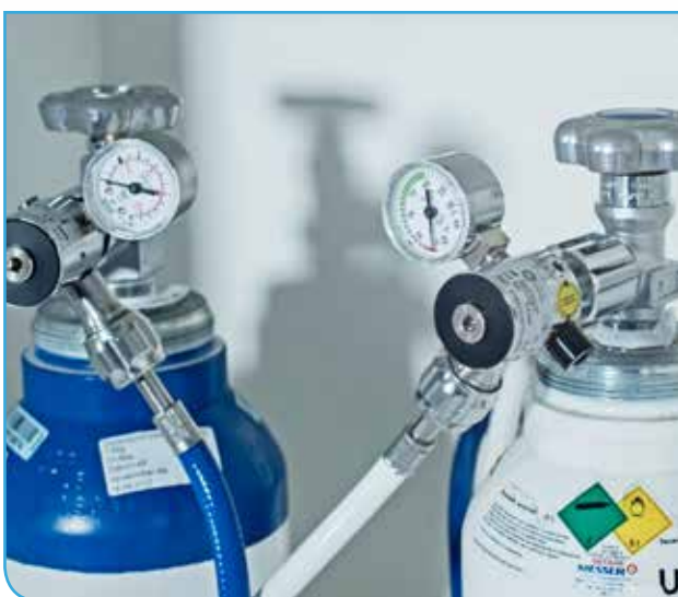
Fig. 8: Reductores de presión conectados a las bombonas de gas.
